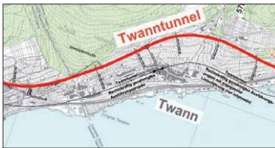
Die Linienführung des geplanten 1,8 Kilometer langen Tunnels.
